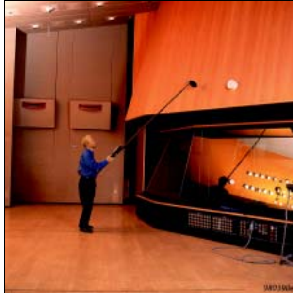
Fig. 16 Cartographie de l'affaiblissement acoustique pour détection des fuites entre studio et régie d'une salle d'enregistrement
